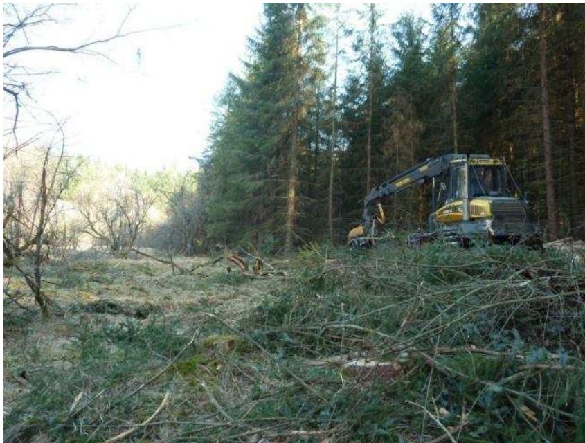
Abatteuse 8 roues et chenilles réalisant le tapis au fur et à mesure de la coupe
