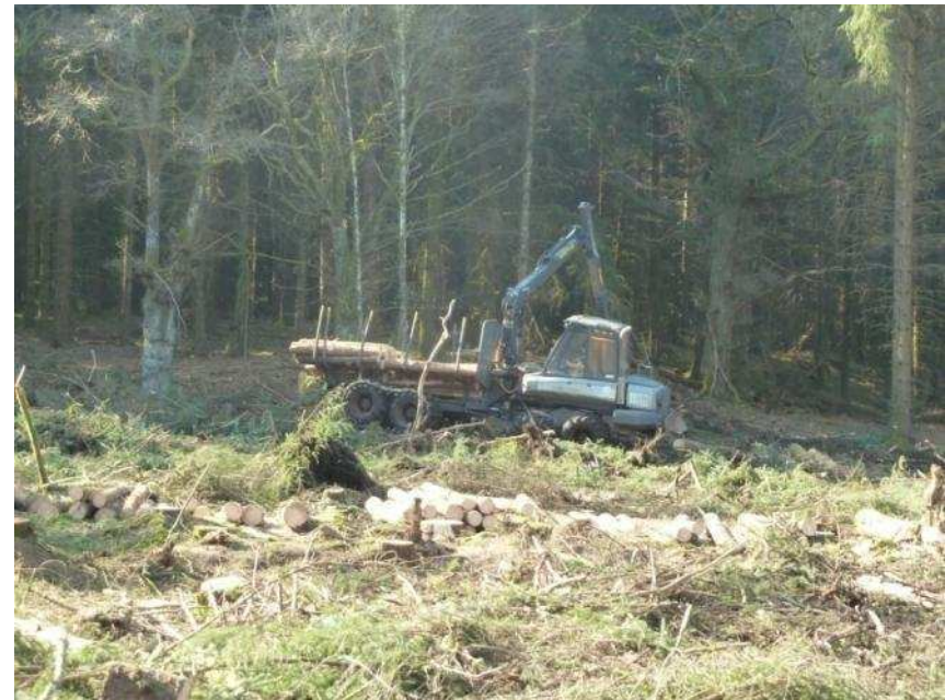
Porteur faiblement chargé pour limiter l'enfoncement
