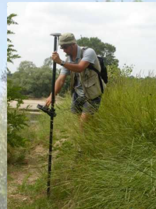
Relevés topo-bathymétriques (Echosondeur - GPS RTK & station totale)
