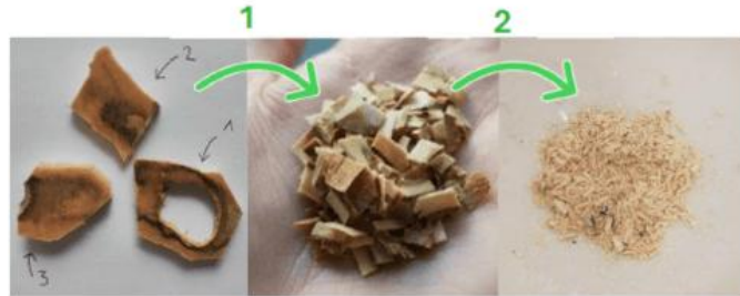
Figure 7 : Evolution des échantillons de bois au fur et à mesure des étapes de broyage. 1 : Prédécoupage au ciseau à bois. 2 : Broyage manuel à l'azote liquide
