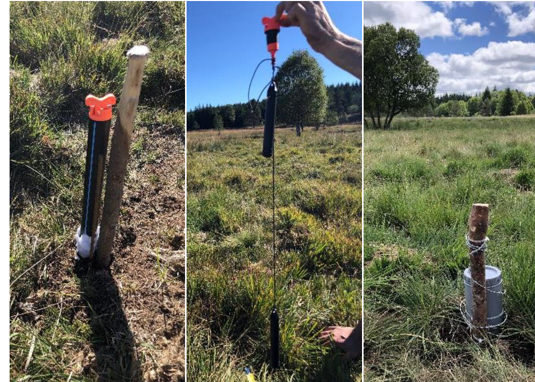
Piézomètre avec sonde automatique
